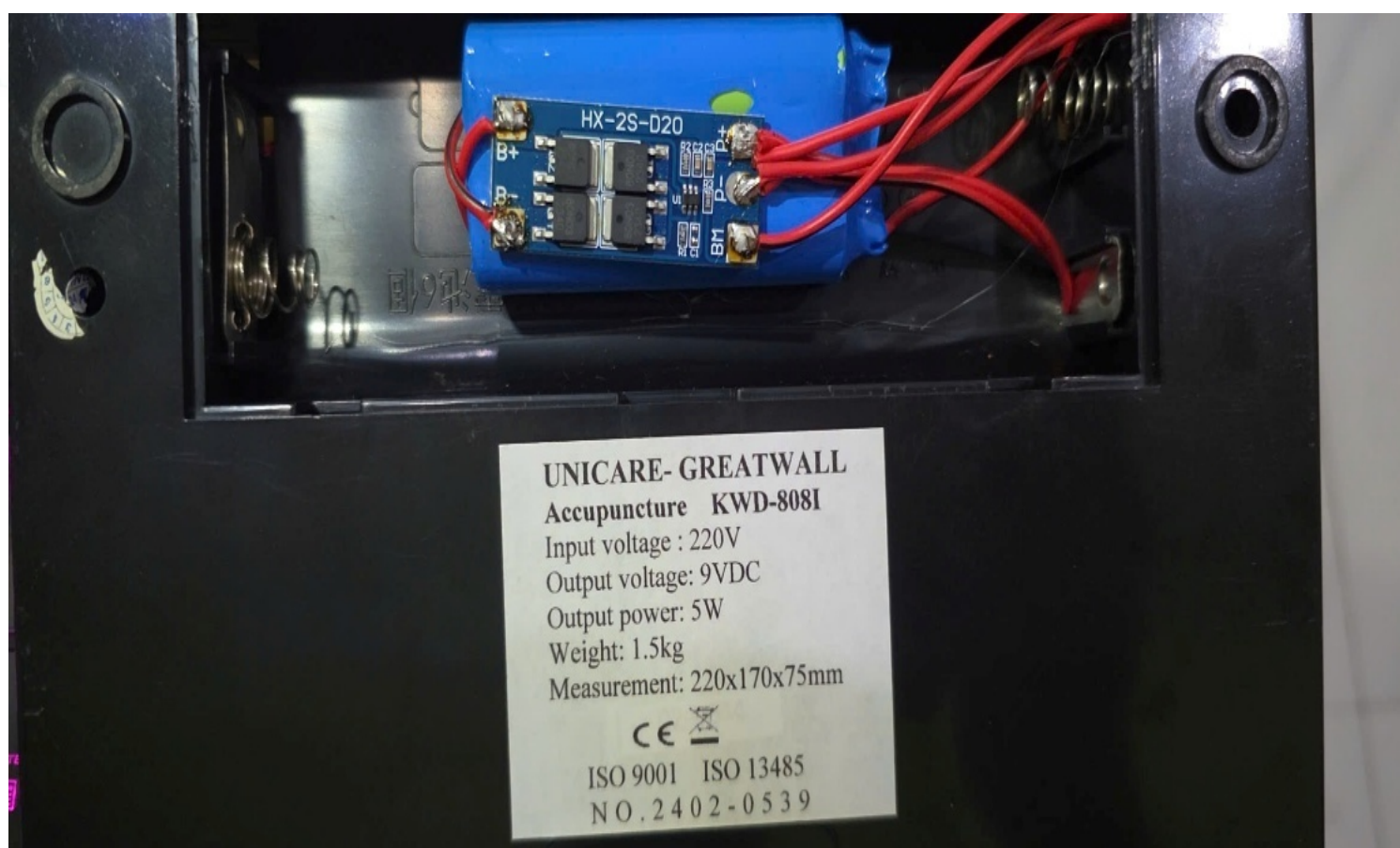
Pin 18650 được lắp vào vị trí pin dùng 1 lần của máy
